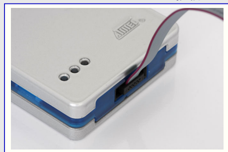
図2-4. Atmel JTAGICE3ケーブル接続
