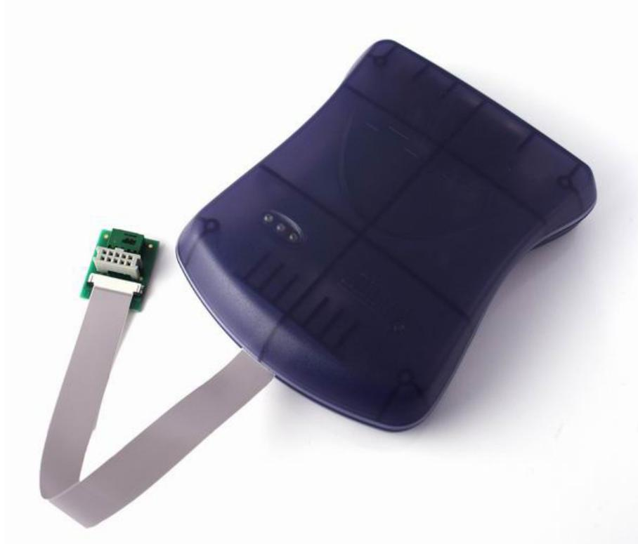
Atmel<sup>®</sup> AVR<sup>®</sup> JTAGICE mkIIは全てのAtmel AVR 8及び32ビット マイクロ コントローラとチップ上デバッグ能力を持つプロセッサでのチップ上デバッグとプログラミングを支援します。
