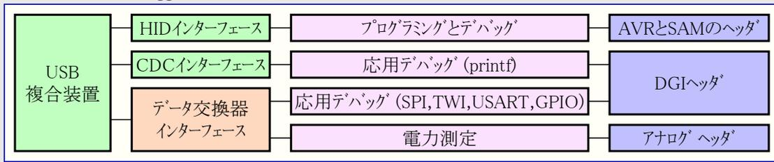
図6-2. Power Debugger構成図
